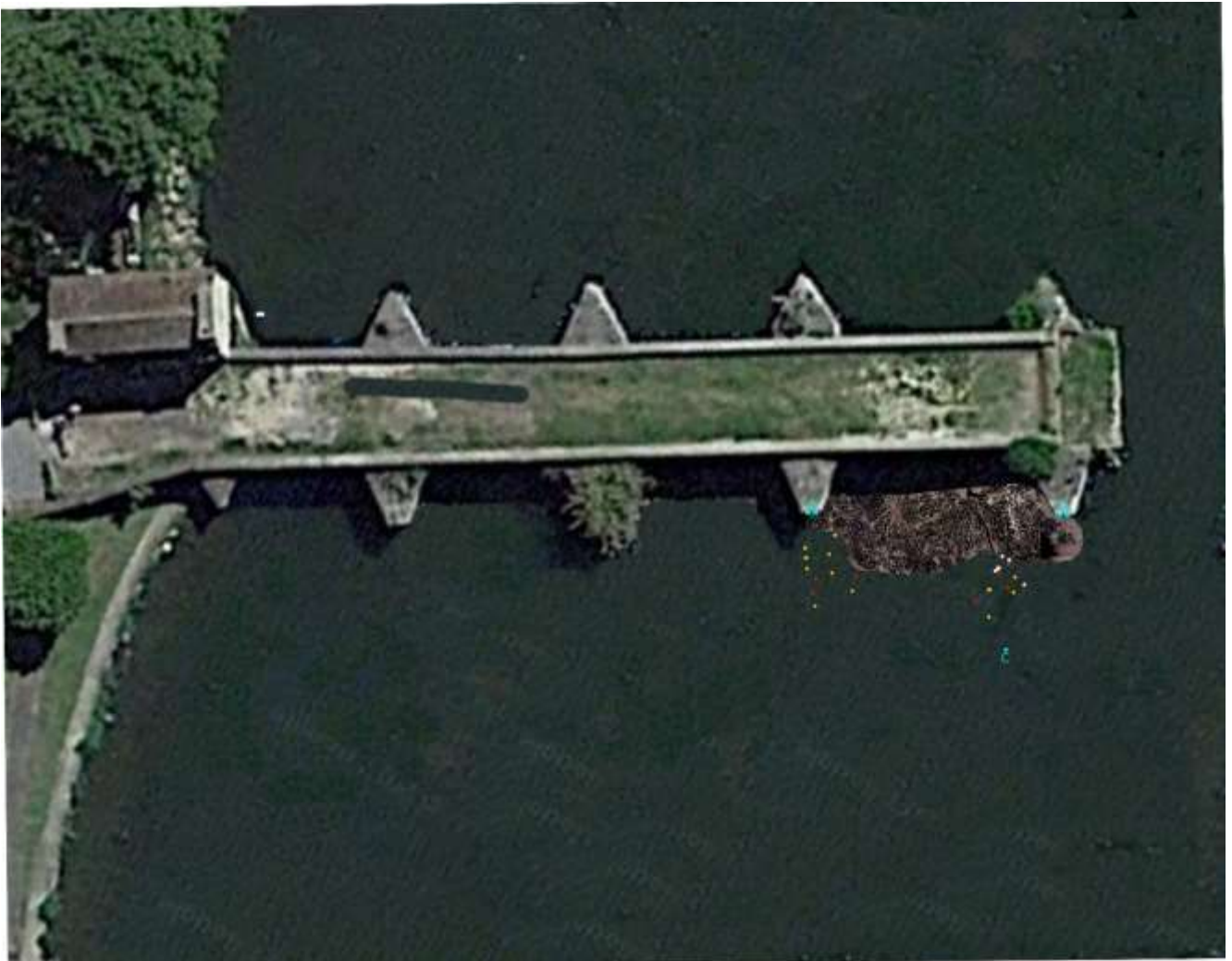
Figure II-15: Zone d'empierrement correspondant au bâti du moulin
